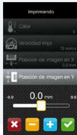
Pos. de impresión en Y Corredera para ajuste rápido, teclas ± para ajuste fino
